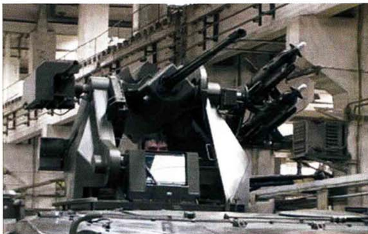
OWS 25R, купола са топом 25 mm КВА која се уграђује на модернизоване румунске транспортере MLI-84M
